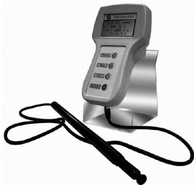
Şəkil 3.1. Hava mühitinin iqlim parametrlərini ölçən «Meteoskop».
